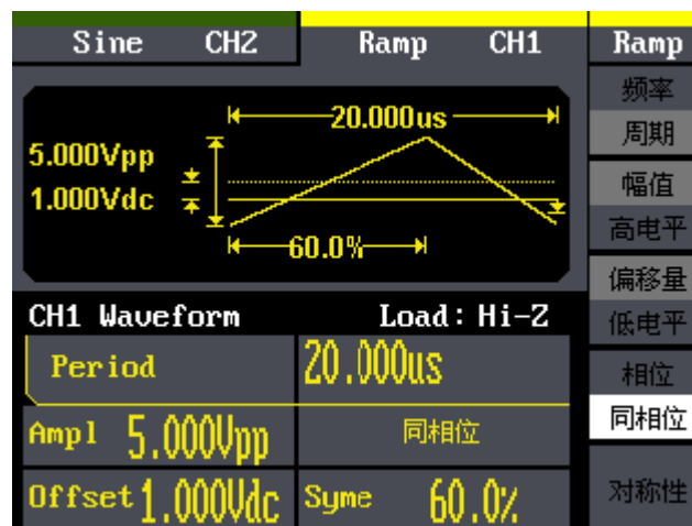
图 3-3 输出三角波/锯齿波形
