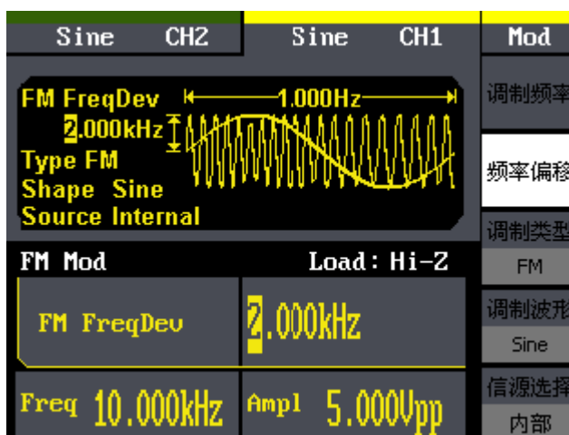
图 3-11 输出 FM 调制波形
