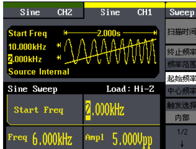
图 3-7 输出线性扫描波形
