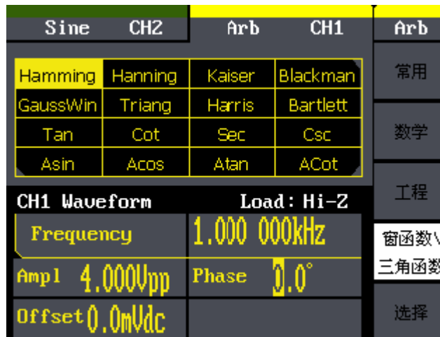
图 2-19 窗函数\三角函数内建波形显示界面
