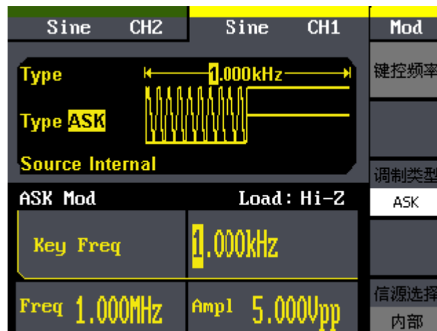
图 3-14 输出 ASK 调制波形
